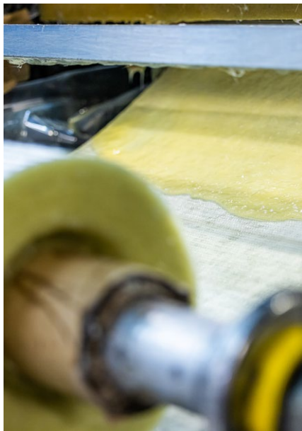
Die Imprägnieranlage tränkt das GFK-Gelege gleichmäßig mit Reaktionsharz
